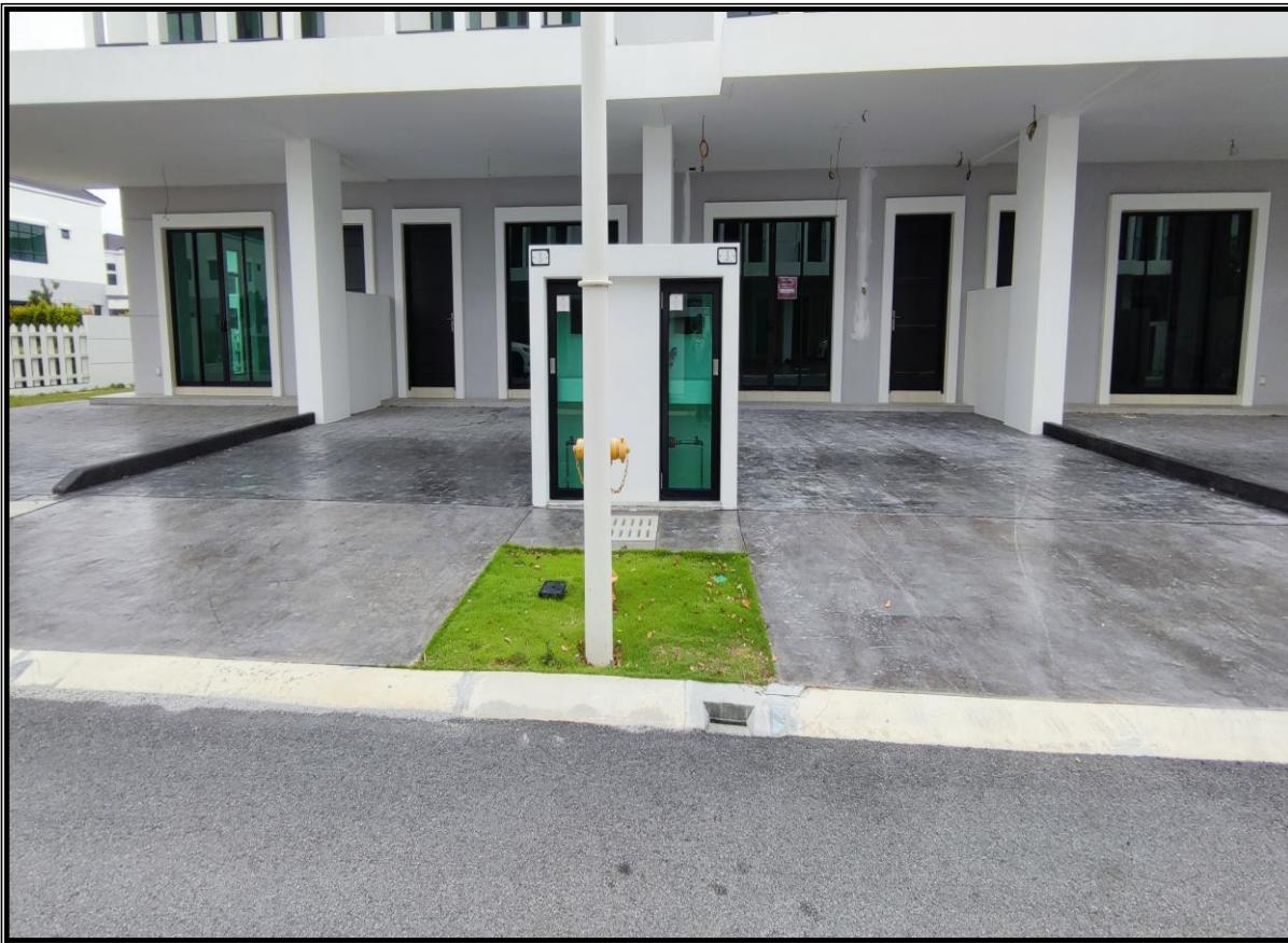
**Gambar C:** Kemudahan Utiliti (Tiang Lampu, Pili Bomba Dan Lain-Lain) Di Letakkan Di Antara Tembok Pagar Bangunan
