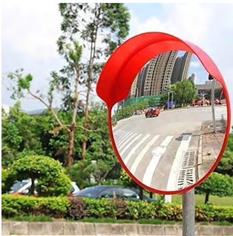
Foto 5.5 : Cermin cembung keselamatan di pasang dipersimpangan
