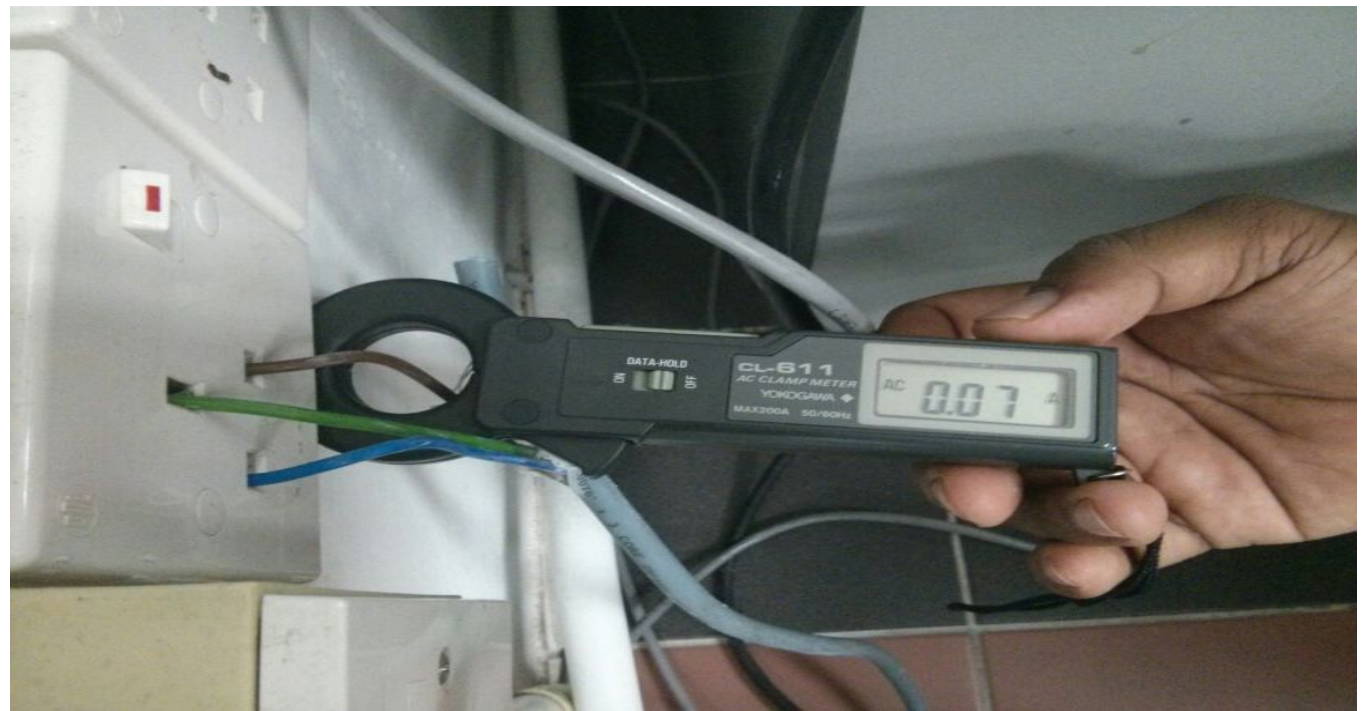
Semasa printing rehat (tidak berfungsi 0.07A) tetapi power supply 13A tidak OFF
